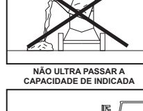
CARREGAR E DE CARREGAR CORRECTAMENTE A BETONEIRA PARA OU MEIO DE TRANSPORTE UTILIZADO (Ver Capítulo de Transporte neste Manual)
